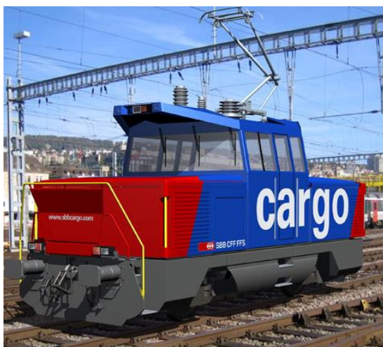
Abbildung 20: Hybridlok Eem 923 der SBB Cargo (Grafik: Stadler Rail)
